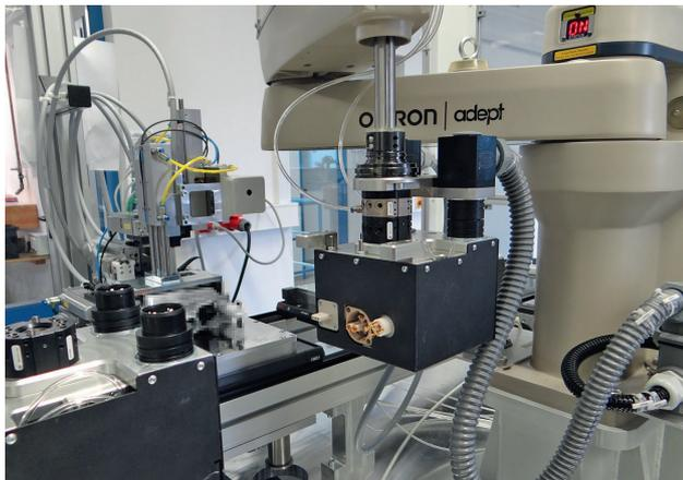
**Bild 2: Kontaktierungskopf mit drei der speziell entwickelten Kontaktierungen zur Strom- sowie Spannungsprüfung und dem Roboter, der diese handhabt. Die Kontaktierungen von links nach rechts: Niederspannung und LIN-Bus, Hochspannung, Massebolzen**
